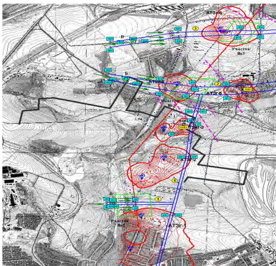
Hình.1. Đường viền dị thường địa điện của ATZ và ranh giới của vùng thấm khí Các "kênh" trên bản đồ địa hình khu vực phân bố khai thác mỏ than
