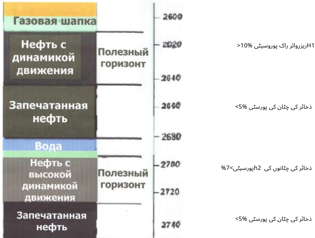
تصویر 3۔ پیمائش کے مقام پر گہرا کالم (یوٹاہ، امریکہ)۔ تیل کے ذخائر کی کل موٹائی: H = h_1 + h_2 = 70m تیل سے سیر شدہ چٹانوں کی کل موٹائی 140 میٹر
