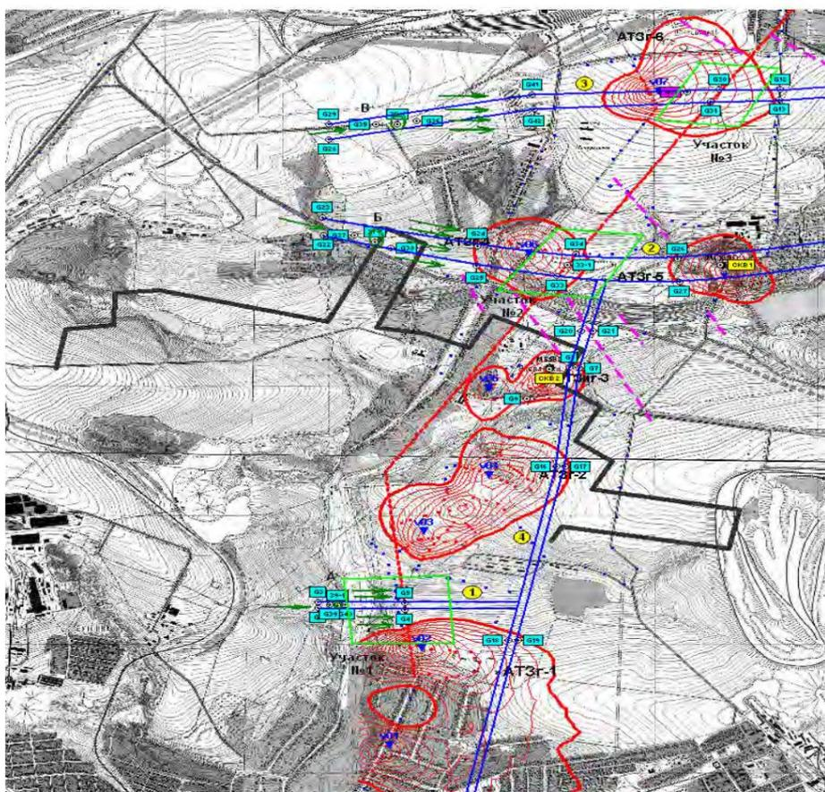
**Figura 5. Contornos de anomalias geoeletricas da ATZ e limites de "canais" permeáveis a gás em mapa topográfico da seção de distribuição de mineração da mina de carvão A.F. Zasyadko [17].**
