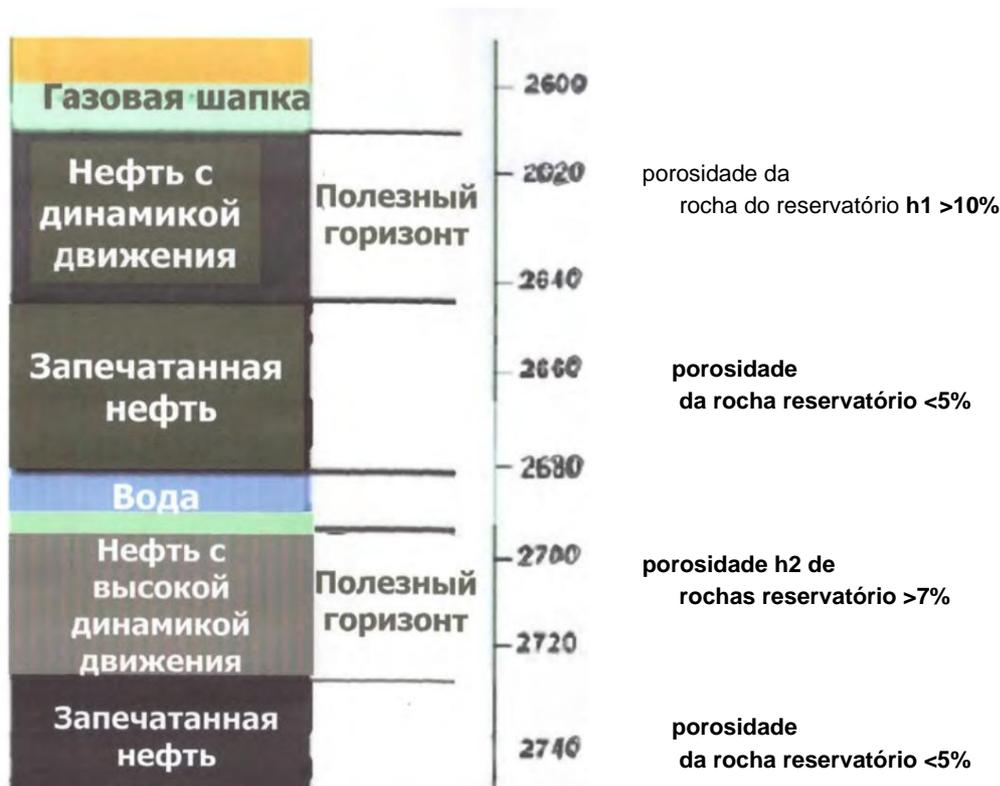
**Figura 3. Coluna profunda no ponto de medição (Utah, EUA). Espessura total dos reservatórios de petróleo  $H=h_1+h_2=70m$ ; espessura total de rochas saturadas de óleo – 140 m**
