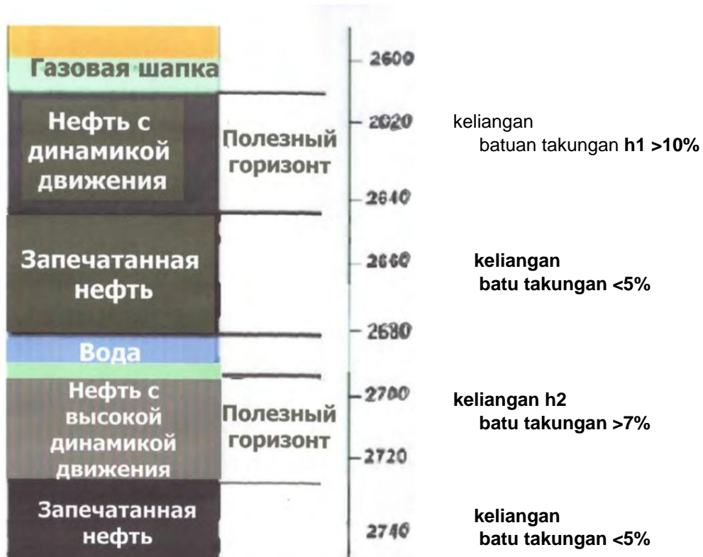
Rajah.3. Lajur dalam pada titik pengukuran (Utah, AS). Jumlah ketebalan takungan minyak H=h_1+h_2=70m ; jumlah ketebalan batuan tepu minyak – 140 m
