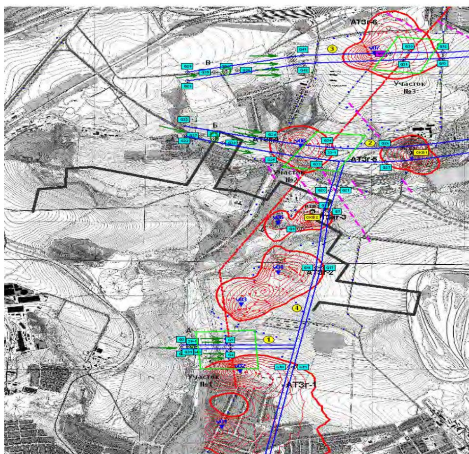
Rajah.5. Kontur anomali geoelektrik ATZ dan sempadan "saluran" telap gas pada peta topografi bahagian peruntukan perlombongan lombong arang batu A.F. Zasyadko [17].
