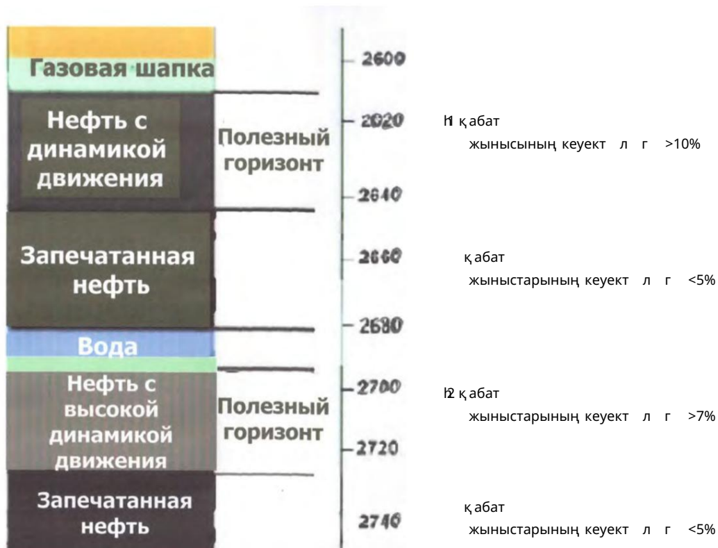
3-сурет. Өлшеу нүктесіндегі терең бағана (Юта, АҚШ). Мұнай қабаттарының жалпы қалыңдығы H = H_1 + H_2 = 70 м; мұнайға қаныққан жыныстардың жалпы қалыңдығы – 140 м
