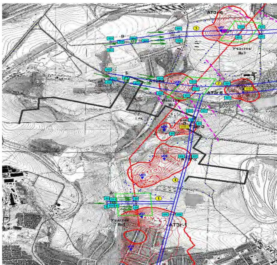
Fig. 1. Contours des anomalies géoélectriques de l'ATZ et limites des perméables aux gaz "canaux" sur la carte topographique de la zone d'attribution minière de la mine de charbon nommé d'après A.F. Zasyadko [17].
