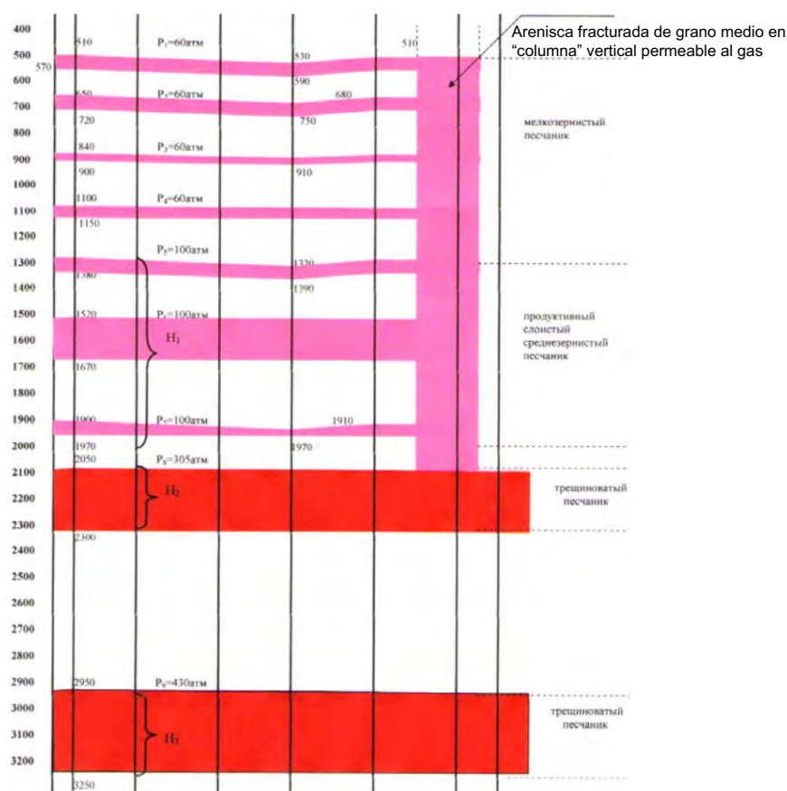
Fig.4. Perfil de profundidad de la sección de gas No. 1G en el campo minado (mina "Zarechnaya", Rusia). Se
