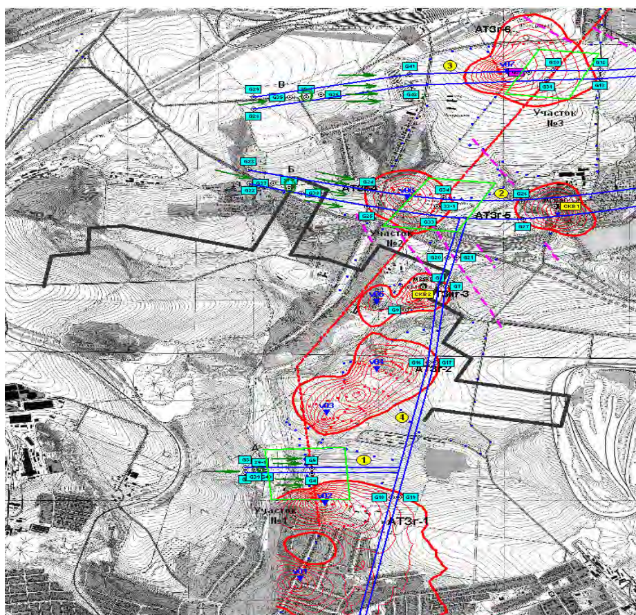
Рис.1. Контурные геоэлектрические аномалии АТЗ и границы газопроницаемых «каналов» на топографической карте участка горного отвода угольной шахты им.А.Ф.Засядько [17].
