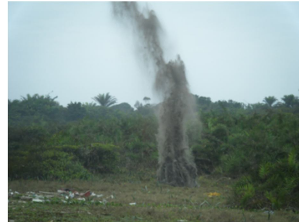
Tir sismique à l'explosif (Document AGAP)
